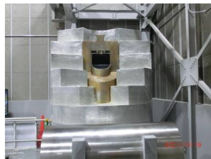
人工物を組み合わせた多重バリアシステム(ガラス固化体サンプル+オーバーバック+緩衝材)
