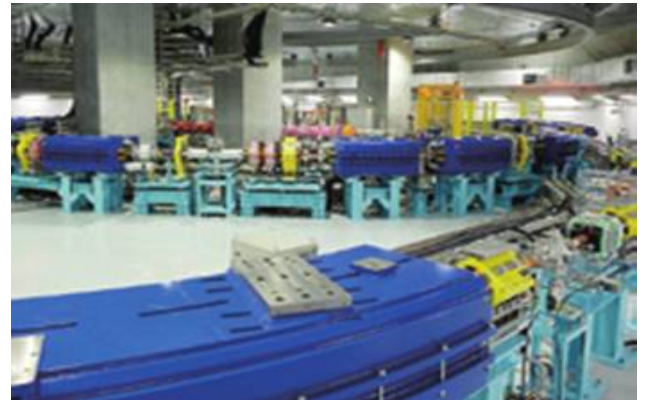
—炭素イオンを超高速に加速するため、直径20mもの大型の円形加速器が、この施設の半分以上を占めている—
