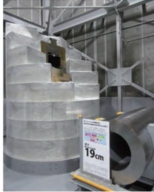
は、高さ約3.1m横幅約2.8mで、これが地層処分されます。一個のガラス固化体がバリアで保護された大きな姿になります。
